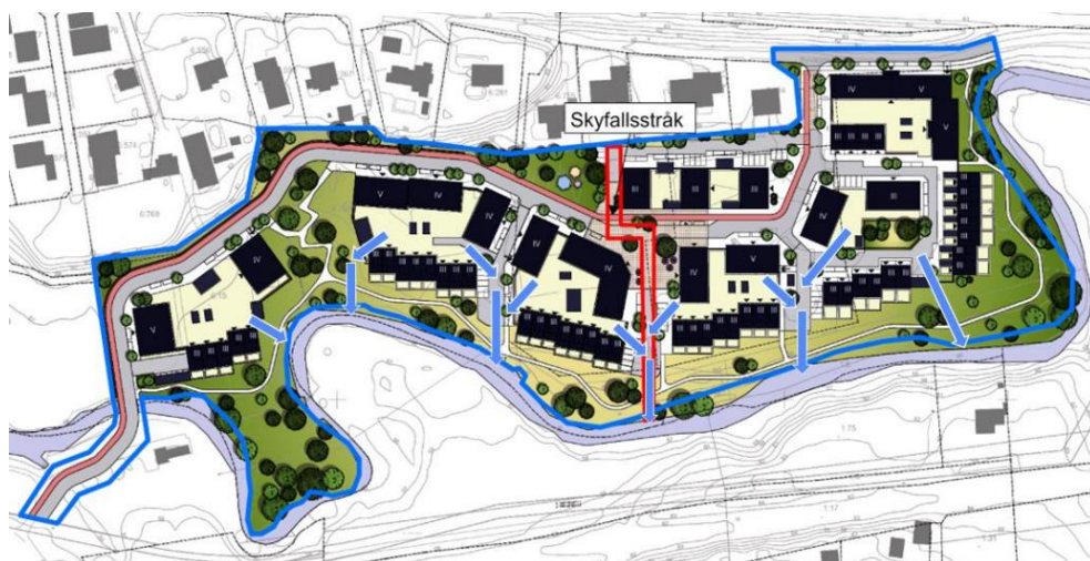
Figur 17. Föreslagen skyfallsgata inom planområde. Blå pilar visar dagvattnets flödesriktning. Figur från Sweco, 2024.
