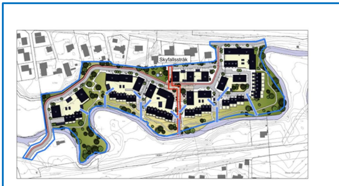
Figur 16: Skyfallsstråk samt dagvattnets flödesriktning
