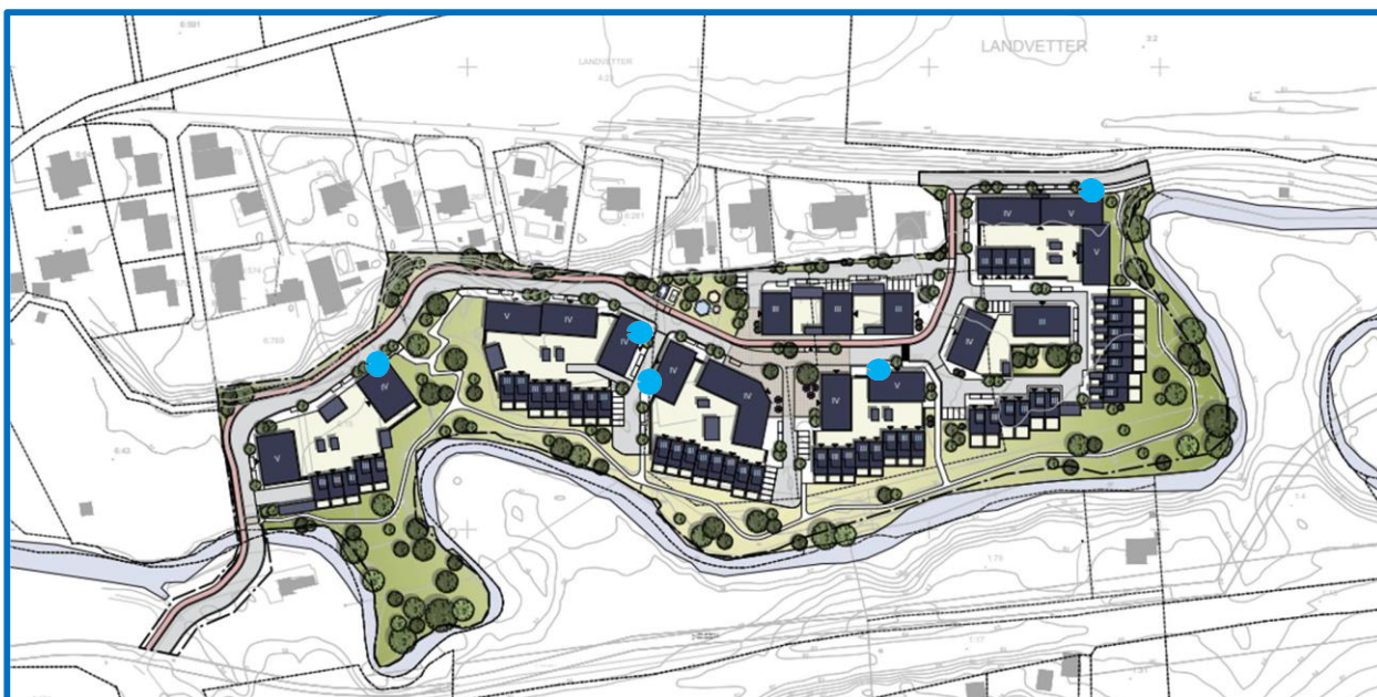
Figur 18: In- och utfarter till parkeringsgarage
