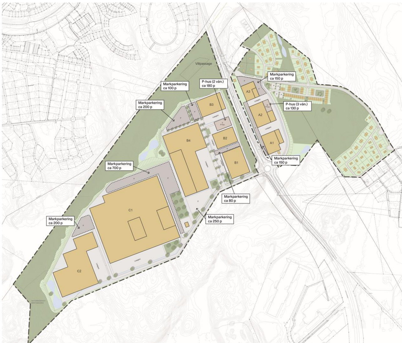
Figur 66. Antal parkeringsplatser vid respektive parkeringsyta. Källa: White Arkitekter/GFS Konsult. Illustrationen återfinns även i bilaga 1.
