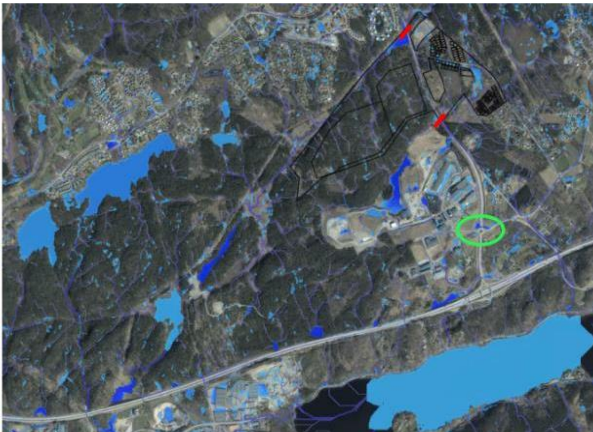
Figur 13.4. Avrinningsstråk (blå streck) och lågpunkter (blå områden) som översvämmas vid skyfall (50 mm regn) vid befintliga förhållanden. Planområde och planerad utbyggnad visas med svarta streck, röda streck visar befintliga vägtrummor och grön cirkel visar befintlig GC-tunnel (WSP, 2024f).
